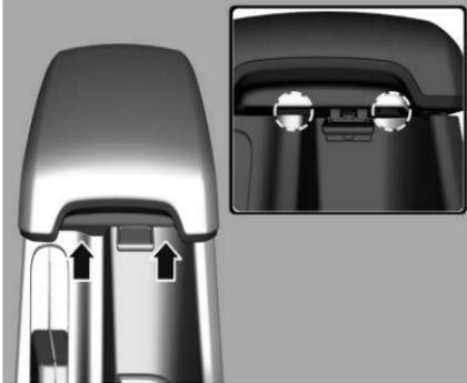
El reposabrazos tiene una ruta para el cable auxiliar.
