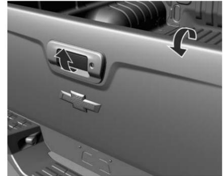
Para abrirla, jale la manija central y baje la puerta trasera. Para cerrarla, levante la puerta trasera y presione sobre los extremos superiores hasta oír un ruido de bloqueo.
