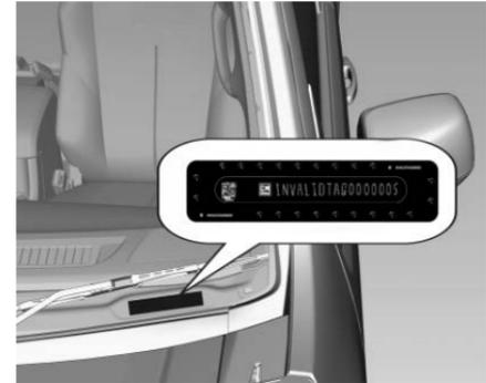
El Número de identificación del vehículo está grabado en el tablero de instrumentos y es visible a través del parabrisas.
