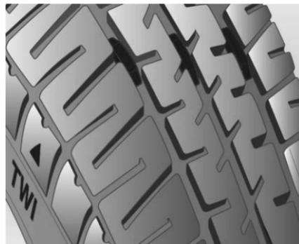
Las llantas se deben reemplazar también cuando la profundidad de la banda de rodamiento se desgaste cerca de 1.6 mm. La imagen muestra dónde se puede encontrar la profundidad de la rodada.
