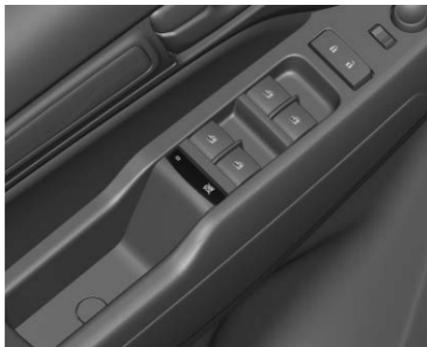
Oprima el interruptor
