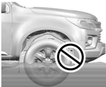
Conduzca a baja velocidad a través de cualquier área inundada y asegúrese de que el límite del agua no supere la altura del centro de la rueda.
