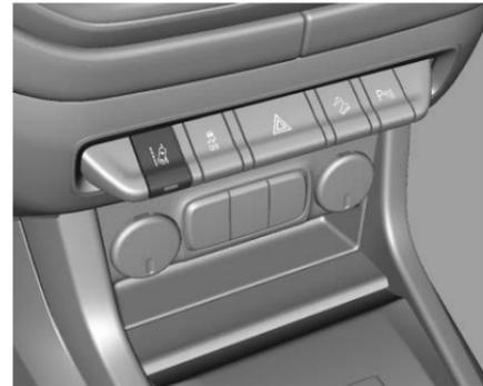
Si está equipado, LDW puede ayudar a evitar choques debido a alejamientos involuntarios del carril. Puede proveer una alerta si el vehículo está cruzando un carril sin usar una direccional en esa dirección. LDW utiliza una cámara para detectar las marcas de carril a velocidades de 56 km/h (35 mph) o mayores.
