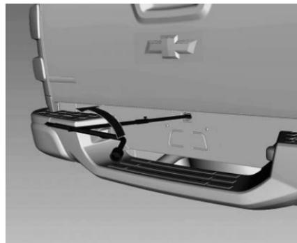
3. Haga girar la llave para las ruedas en sentido inverso al de las manecillas del reloj para bajar la llanta de refacción al suelo. Continúe girando la llave para las ruedas hasta que la llanta de refacción pueda sacarse de debajo del vehículo.
