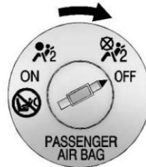
Si el tablero de instrumentos tiene el interruptor que aparece en la ilustración, el vehículo tiene un interruptor de encendido-apagado de bolsa de aire que puede usar para activar o desactivar en forma manual la bolsa de aire del pasajero externo.
