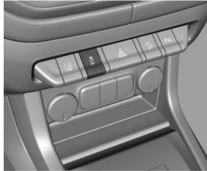
El Control de tracción se puede apagar cuando se requiere el deslizamiento de la rueda de tracción presionando el botón
