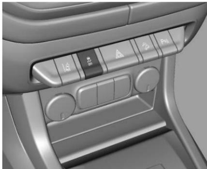
Para conducción de muy alto desempeño, se puede desactivar el sistema ESC presionando y sosteniendo el botón
