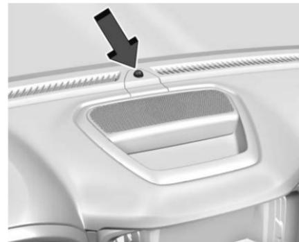
El vehículo tiene un sensor de luz localizado en la parte superior del tablero de instrumentos que controla el Sistema automático de faros delanteros. No cubra el sensor, de otra manera los faros podrían encenderse cuando no sea necesario.
