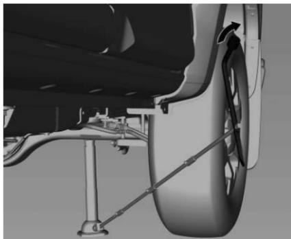
Si la llanta pinchada se encuentra en la parte trasera, coloque el gato debajo del eje trasero, tan cerca del amortiguador como sea posible.
