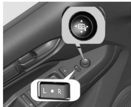
Mueva el interruptor selector a L (izquierda) o R (derecha) para elegir espejo del conductor o del pasajero, respectivamente. Mueva el espejo a la dirección que se desee presionando el interruptor de cuatro vías.
