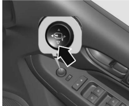
Presione el interruptor selector (interruptor L / R) a la posición central, y presione el interruptor de cuatro vías para plegar los espejos eléctricamente. Oprima nuevamente para desplegar.
