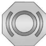
El tapón del depósito del líquido de frenos/embrague hidráulico tiene este símbolo. El depósito común del fluido de embrague/frenos se llena con líquido de frenos DOT 4LV, como se indica en el tapón del depósito. Vea en *Vista general del compartimiento del motor* ⇨ 220 la ubicación del depósito.
