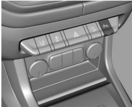
El botón **P**
