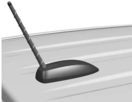
Para retirar la antena del techo, gírela en sentido contrario a las manecillas del reloj. Para instalar la antena del techo, gírela en sentido de las manecillas del reloj.
