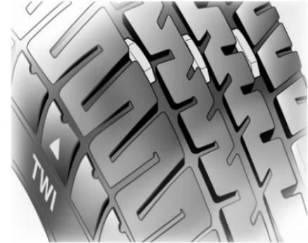
La profundidad mínima permisible de la rodada (1.6 mm) se alcanza cuando la banda de rodadura se haya desgastado hasta uno de los indicadores de desgaste (TWI). Su posición se indica mediante marcas en el costado.
