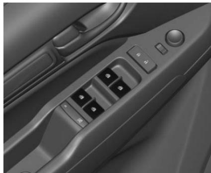
Opere el interruptor para su ventana respectiva oprimiendo para abrir o jalando para cerrar. El interruptor para la ventana del conductor cuenta con una luz la cual indica al iluminarse que está lista para funcionar.
