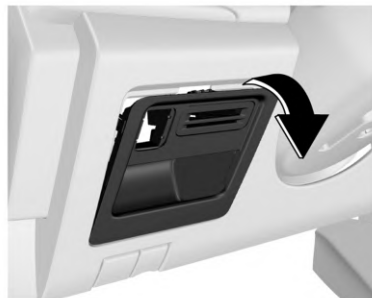
Caja de fusibles interior
